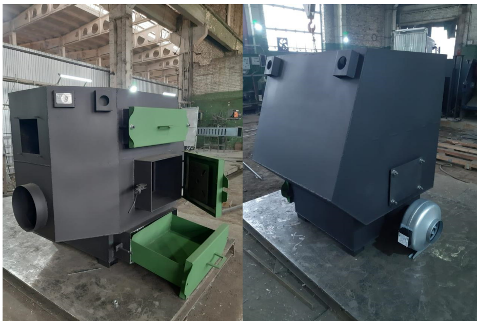
Рис. 1 Большая площадь нагрева, теплообменник теперь изготовлен из листовой стали формованной на прессе. Выдвижной зольный ящик. Самое главное отличие – возможность быстрого подключения автоматической подачи топлива.
