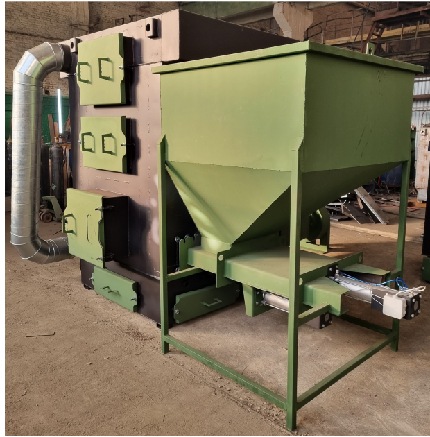
Рис. 3 – Общий вид поршневой подачи топлива, и водогрейного котла GRV
